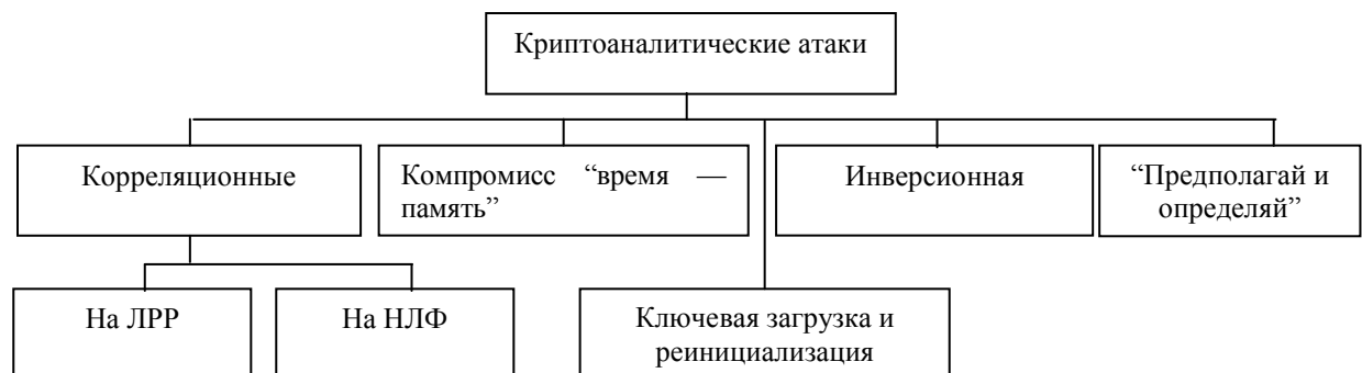
Рисунок 1 – Классификация аналитических атак на схемы поточного шифрования
