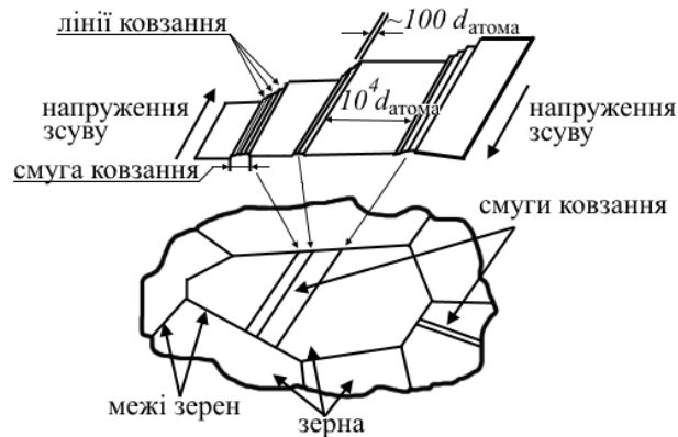
Рис. 3.17. Схематичне зображення ліній та смуг ковзання
