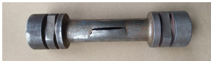
Рис. 7.17. Трубчастий зразок для випробувань під внутрішнім тиском
