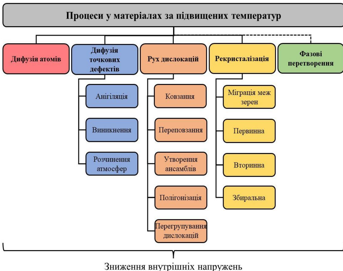
Рис. 4.1. Класифікація процесів, що відбуваються в матеріалах за підвищених температур
