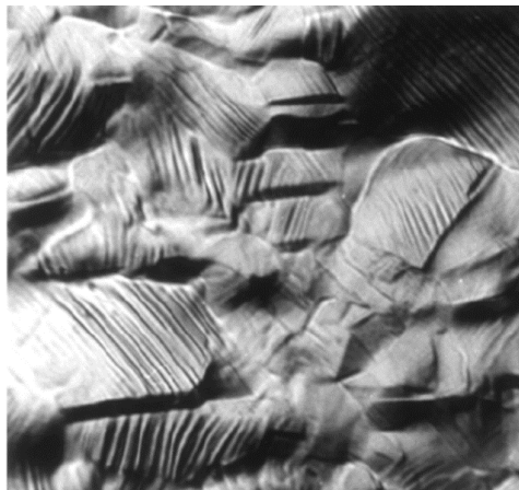
Рис. 3.18. Сходинок ковзання на поверхні полікристалічної Cu [3.1]
