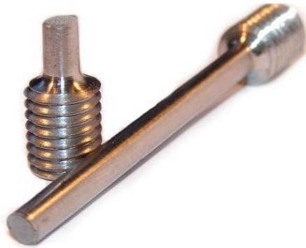
Рис. 5.5. Зразок, зруйнований за крихким механізмом
