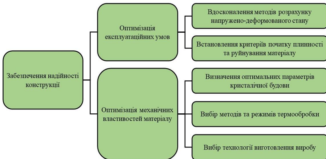
Рис. 9.1. Схема забезпечення надійності експлуатації конструкції
