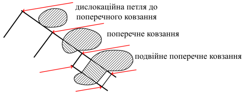
Рис. 3.11. Схема подвійного поперечного ковзання дислокаційної петлі
