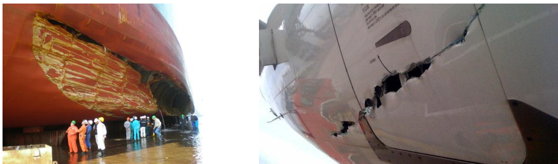
Рис. 7.1. Приклади руйнування великогабаритних виробів у процесі експлуатації: а – нафтовий танкер [7.1]; б – вантажний літак [7.2]
