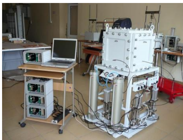
Рис. 7.18. Експериментальні установки для досліджень за умов тривісного навантажування: а – зовнішній вигляд установки для гідростатичного стискання; б – зовнішній вигляд установки для тривісного навантажування
