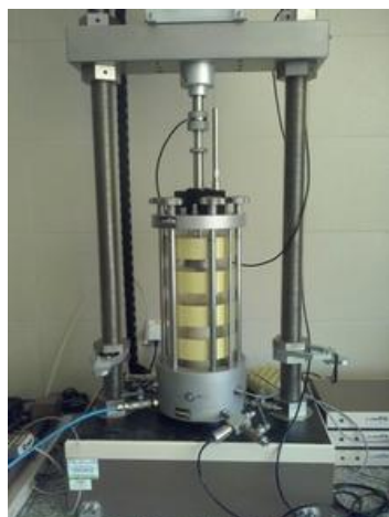
Рис. 7.18. Експериментальні установки для досліджень за умов тривісного навантажування: а – зовнішній вигляд установки для гідростатичного стискання; б – зовнішній вигляд установки для тривісного навантажування
