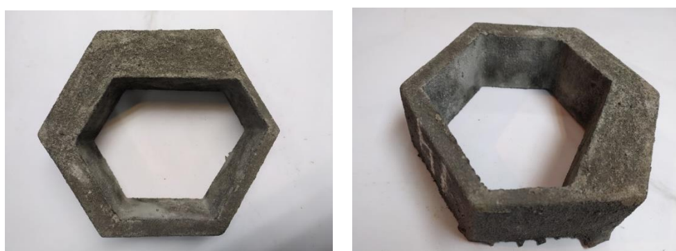
Рисунок 5.7 – Технологічні проби, виготовлені із стрижнями з ортофосфорною кислотою і карбонатом натрію
