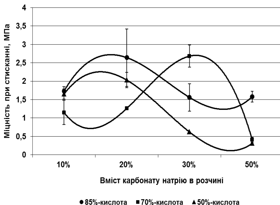
Рисунок 4.22 – Міцність сумішей з розчинами карбонату натрію в ортофосфорній кислоті різної концентрації
