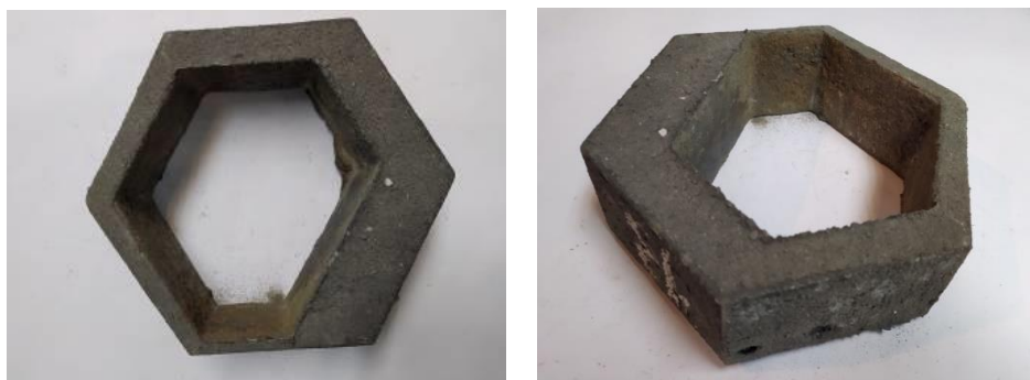
Рисунок 5.6 – Технологічні проби, виготовлені із стрижнями з ортофосфорною кислотою і хлоридом натрію
