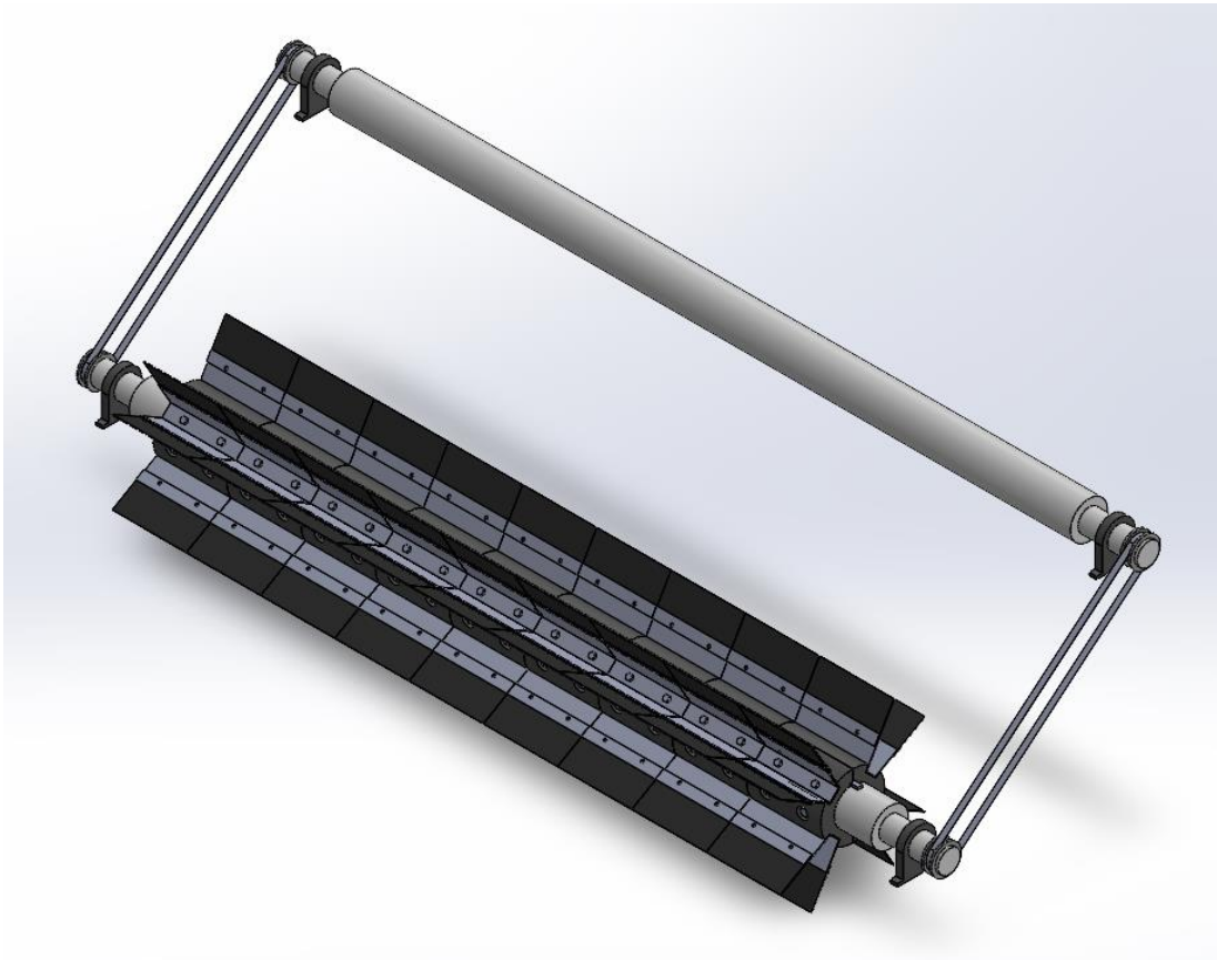
Рисунок 6.1 – Модель модернізованого вузла очищення стрічки
