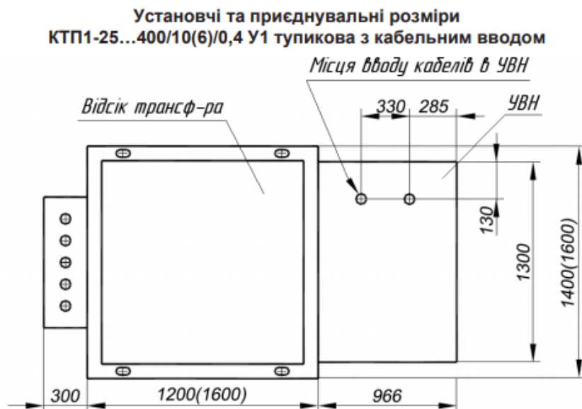
Рисунок 2.7 – Установчі та приєднувальні розміри КТП 1 [14]
