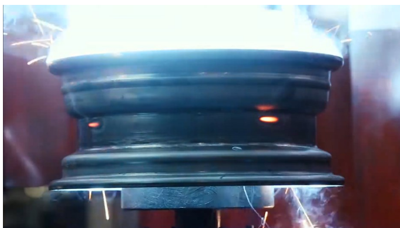
Мал.1.1.4. Зварювання ободу з центром
