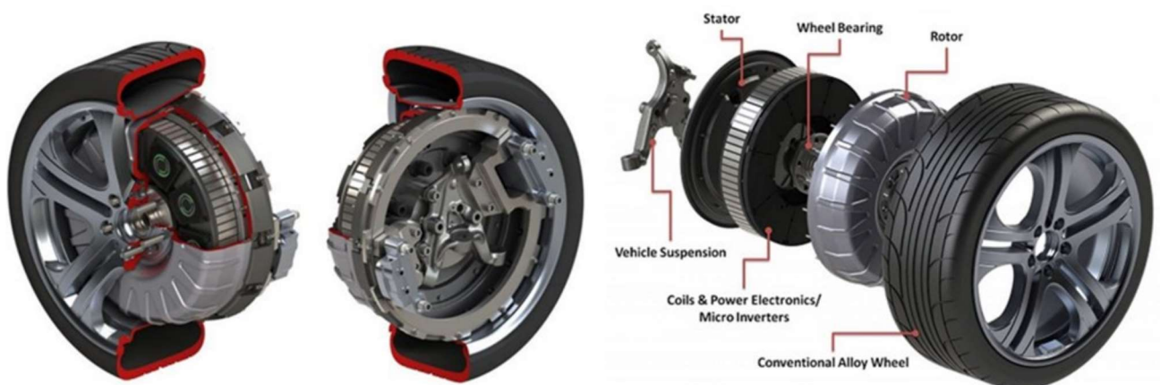
Рисунок 1.3 – Безресорний вузол внутрішньоколісного СДПМ [37]
