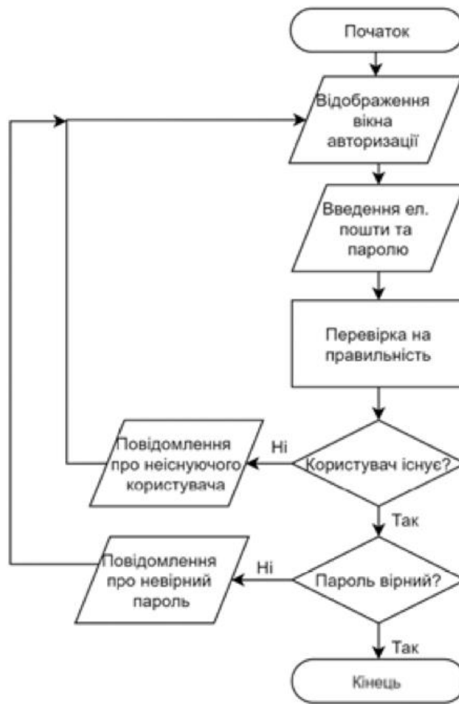
Рис. 3.3. Схема алгоритму, за якою авторизується користувач
