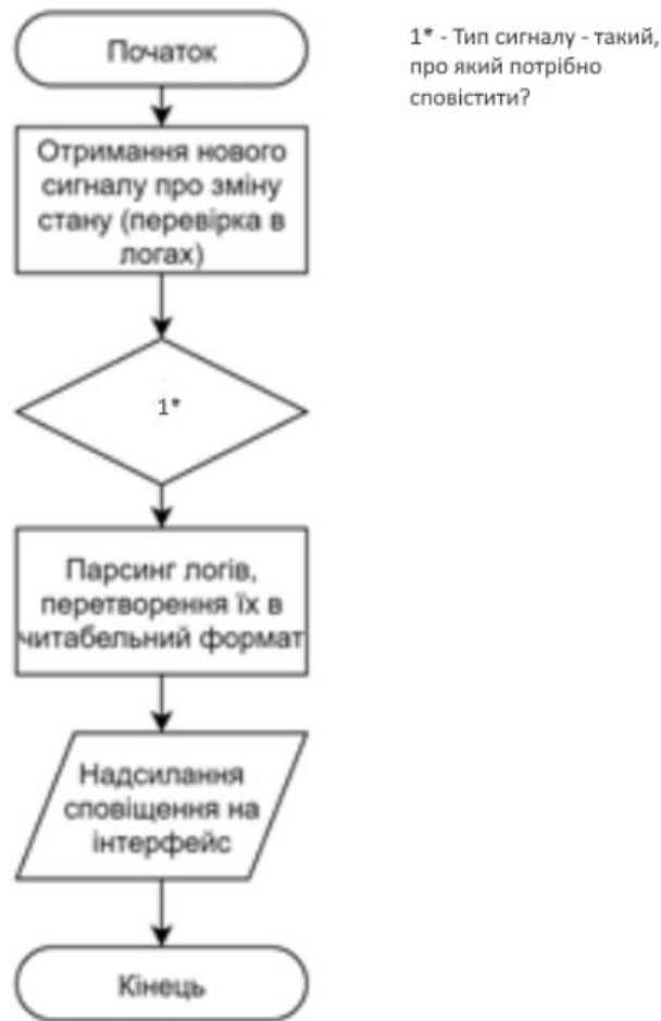
Рис. 2.5. Схема алгоритму, за якою генеруються сповіщення
