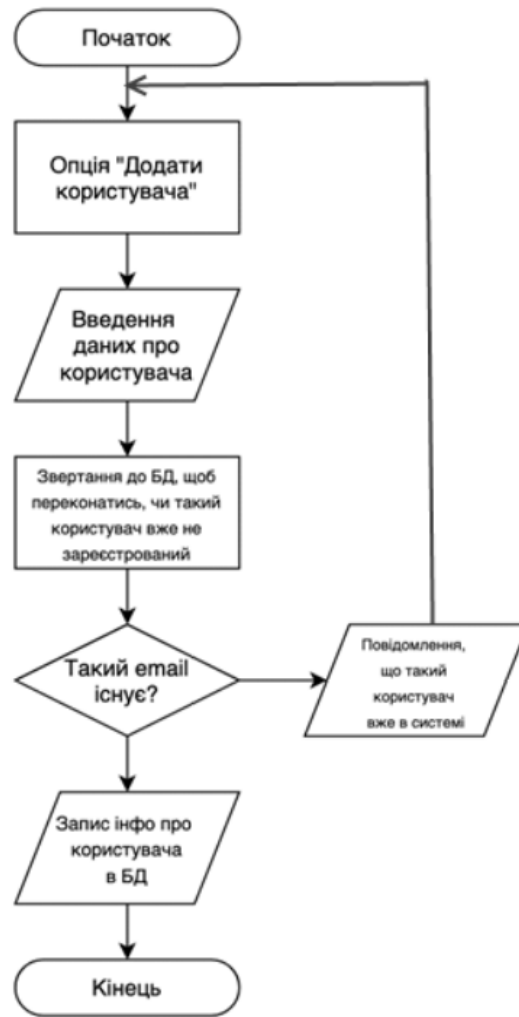
Рис. 3.7. Приклад схеми алгоритму, за якою адміністратор додає нових користувачів.
