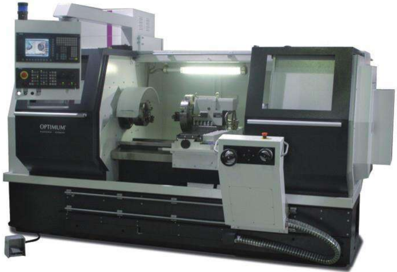
Рис. 4.3.1. Токарний верстат з ЧПК моделі OPTIturn L440.
