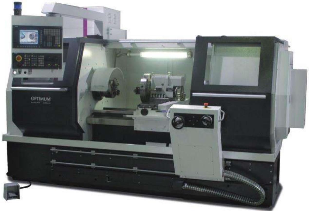
Рис. 4.3.1. Токарний верстат з ЧПК моделі OPTIturn L440.
