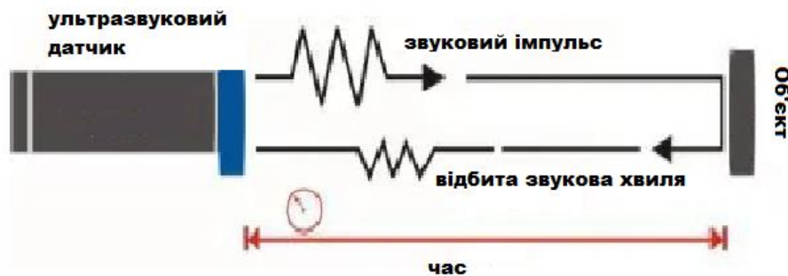
Рис. 1.5 Принцип роботи ультразвукового датчика руху
