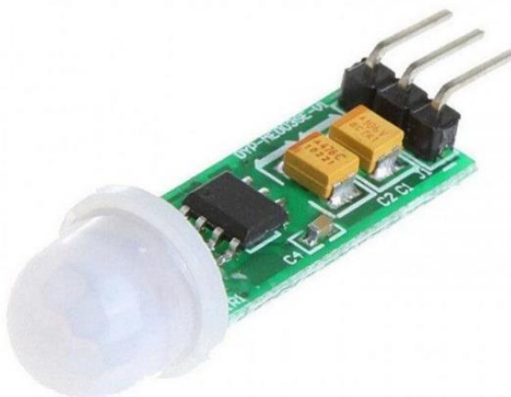
Рис. 1.1 Інфрачервоний датчик руху [9]
