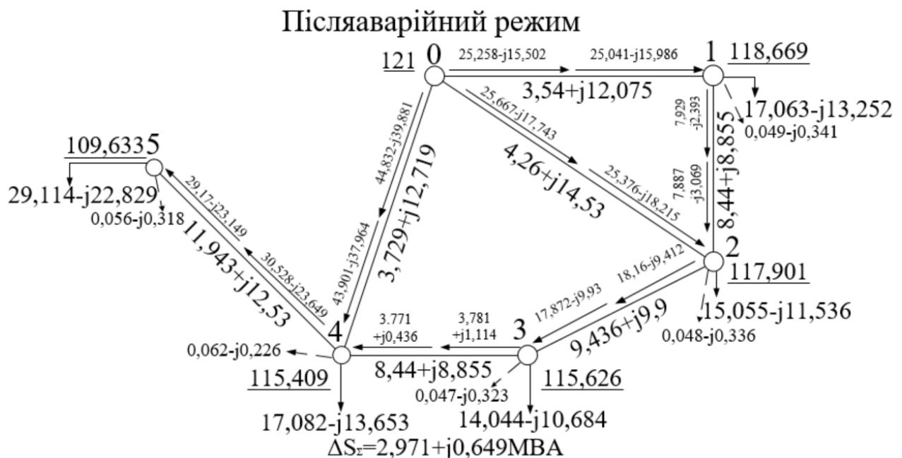
Рисунок 4.6 – Схема з параметрами мережі в післяаварійному режимі.
