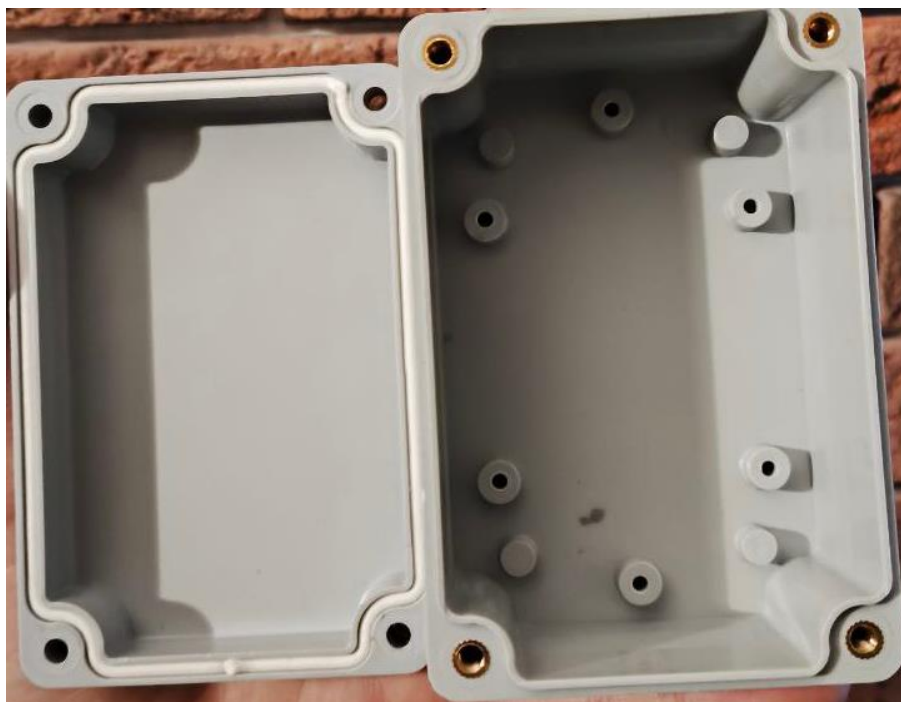
Рисунок 4.2 - Загальний вигляд корпусу до виконання отворів Ущільнювач у заглибленні надійно герметизує корпус після затягування гвинтів кріплення кришки. Детальніше його видно на рисунку 4.3
