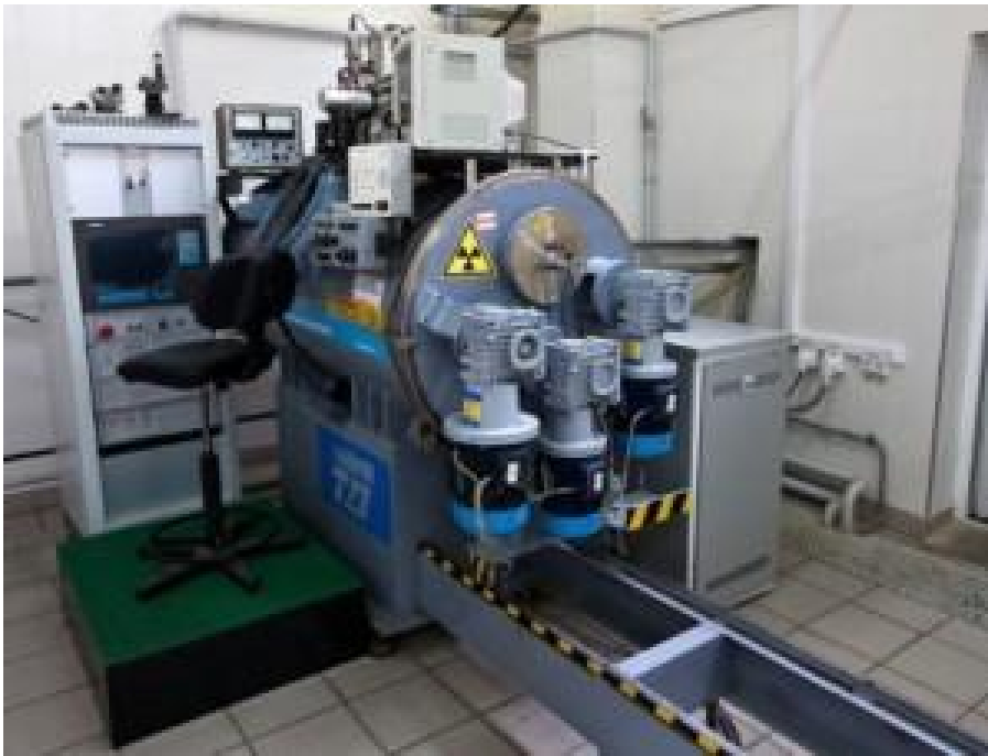
Рисунок 3.4 – Зовнішній вигляд електронно-променевої установки для зварювання з пультом керування
