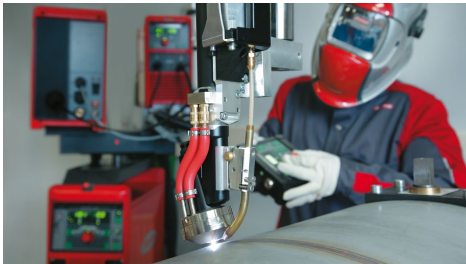
Рисунок 3.6 – Фото реального процесу плазмового зварювання труби на стаціонарній установці Fronius
