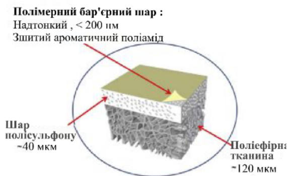
Рисунок 1.6 – Будова поліамідної тонкошарової композитної мембрани [53]
