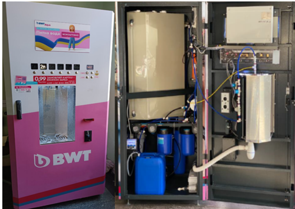
Рисунок 2.3 – Вендинговий автомат розливу води виробництва компанії «Ecosoft-BWT» (Україна)
