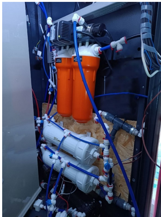
Рисунок 2.4 – Експериментальний вендинговий автомат розливу води
