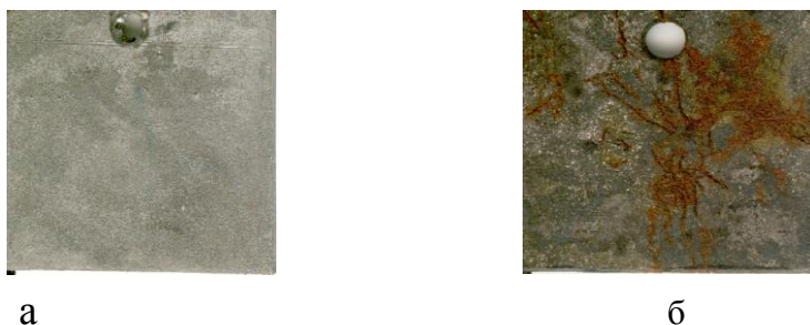
Рисунок 5.1 – Зовнішній вигляд зразків зі сталі 45 з хромосиліцидним покриттям
