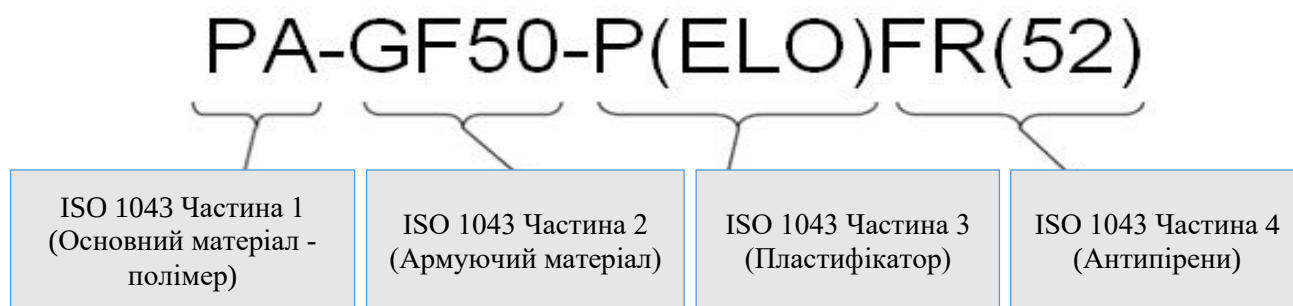
Рисунок 8.5 – Структура маркування згідно стандартів ISO 1043
