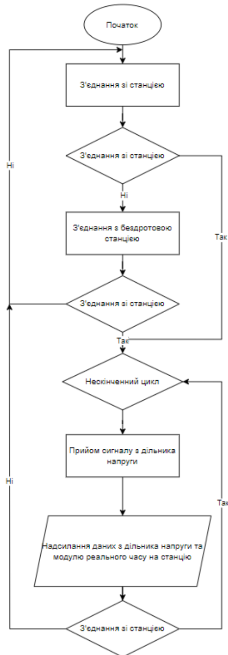
Рисунок 34 – Узагальнений алгоритм передачі даних з мікроконтролера на станцію.
