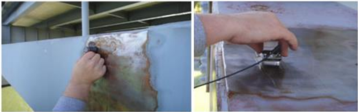
Рисунок 11 – Використання методу ультразвукового контролю [2]
