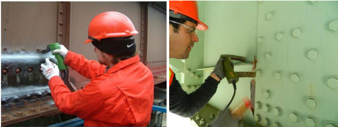
Рисунок 4 – Контроль стану мостових конструкцій методом МПМ [2]
