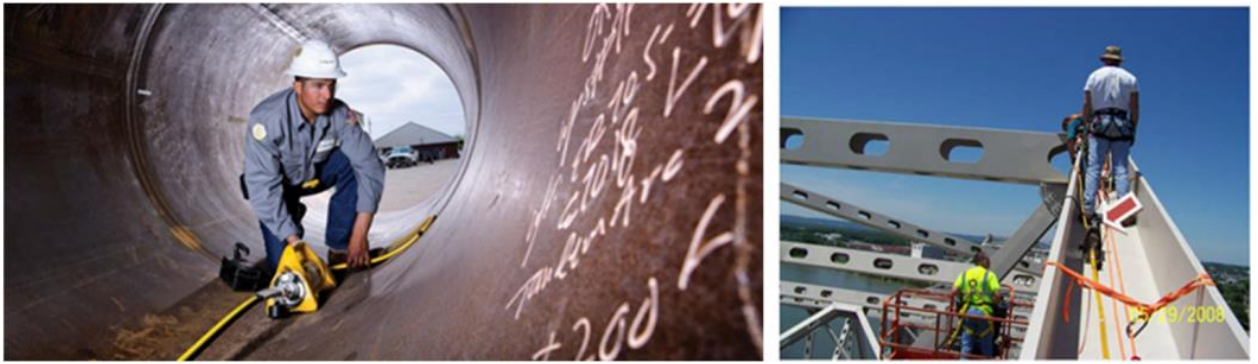
Рисунок 19 – Інспекція сталевих труб радіаційним методом [2]
