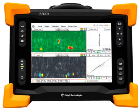
Рисунок 6 – Зовнішній вигляд приладу вихрострумовевого контролю Reddy [7]
