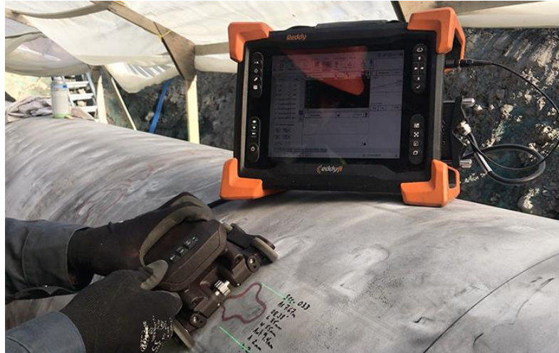
Рисунок 8 – Використання приладу REDDY для виявлення дефектів [7].
