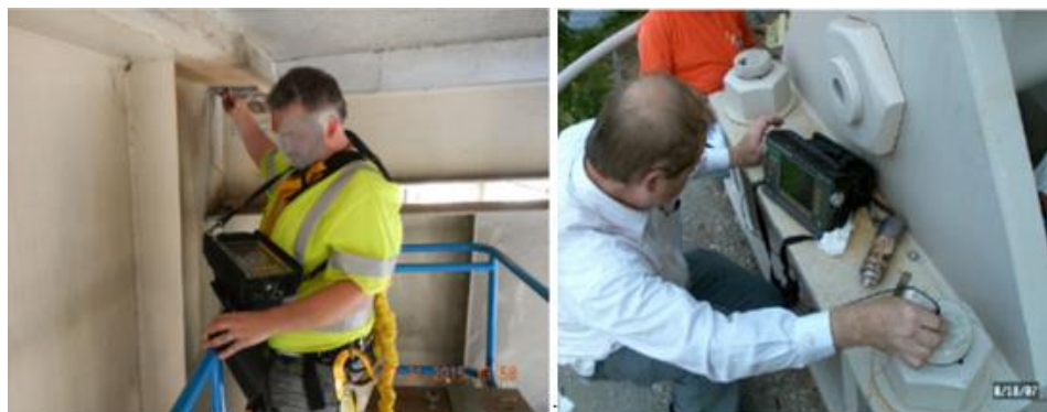
Рисунок 14 – Використання акустичних методів контролю стану мостових конструкцій [2]
