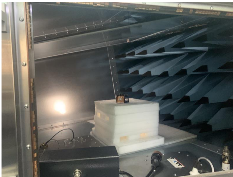
Рисунок 3.5 – Дослідження платформи в безеховій камері GTEM 750
