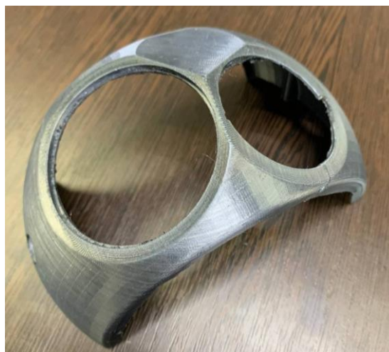
Рисунок 2.7 – Радіопрозорий кожух платформи GS4
