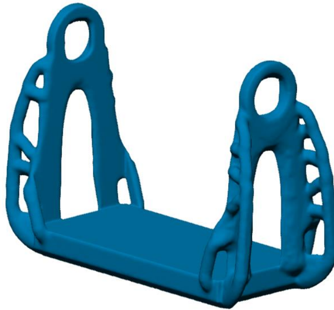
Рисунок 3.36 – Згенерована конструкція рами платформи
