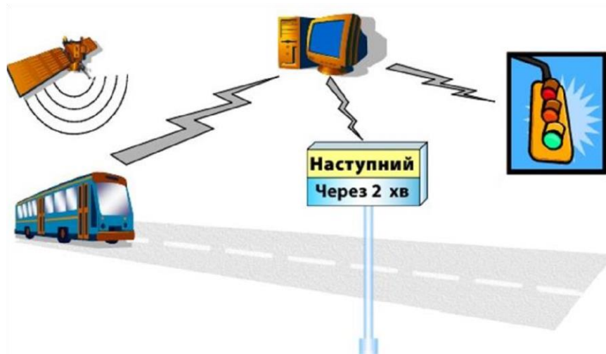
Рисунок 2.6 - Схема обробки інформації, що поступає в реальному масштабі часу про громадський транспорт [6]
