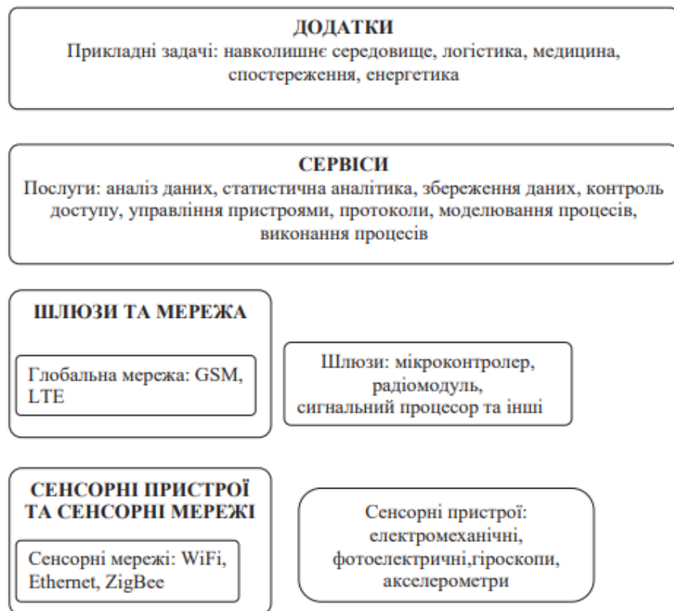
Рисунок 1.3 - Функціональні рівні архітектури IoT[1]
