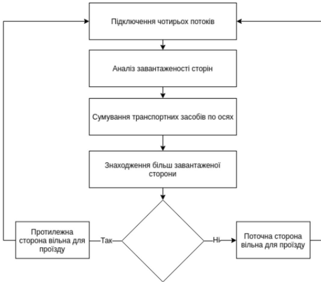
Рисунок 3.7 - Спрощена структура алгоритму системи регулювання дорожнього трафіку[9]
