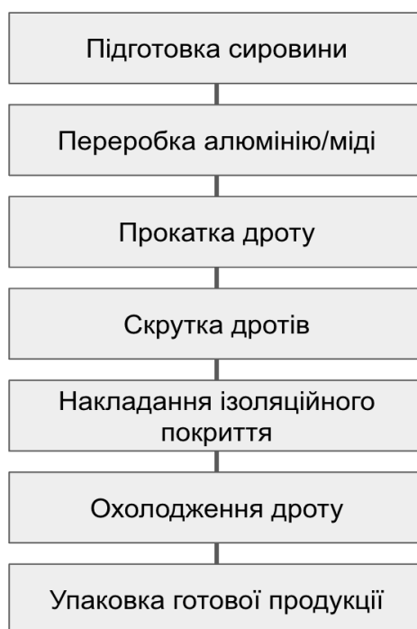
Рисунок 2.2 – Технологічний процес вироблення кабелю на ТОВ "Виробниче підприємство "Укркабель"
