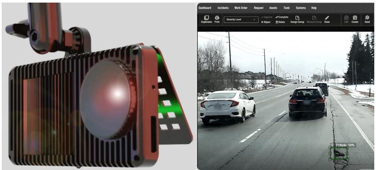
Рисунок 2.3 – Спеціалізоване обладнання для записування дороги та екран вебзастосунку CityROVER
