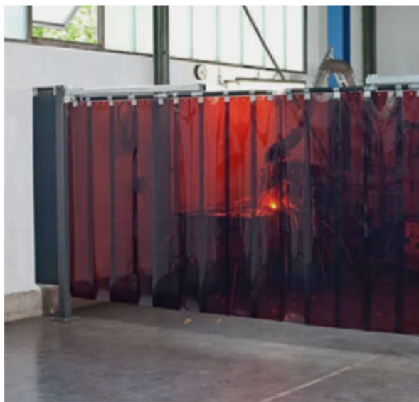
Рисунок 6.3 – Робоче місце зварника, обладнане захисною плівкою [48]
