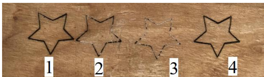
Рис. 3.7 Гравіювання дерева при різних швидкостях
