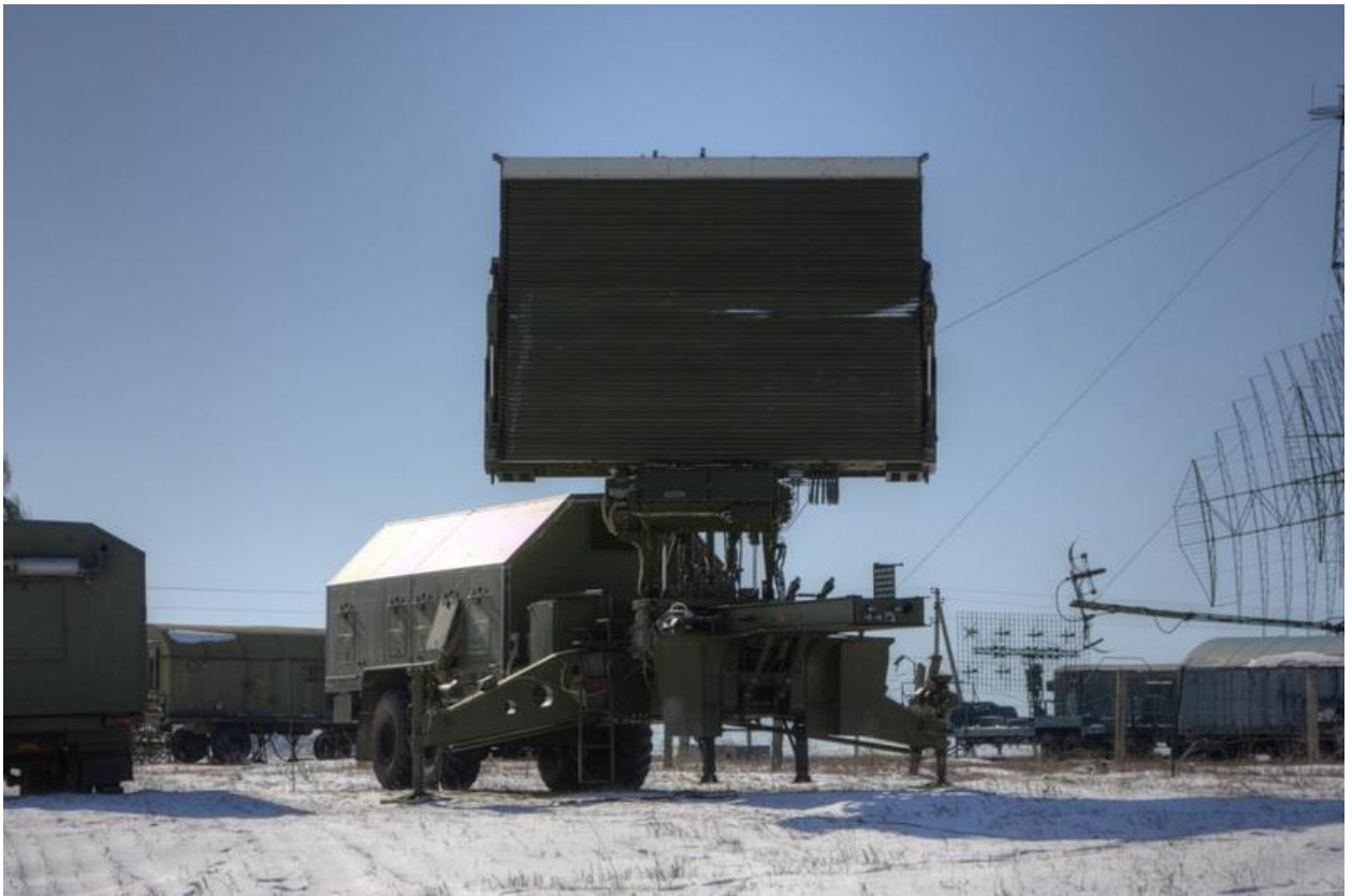
Рис.2.4. Рухома трикоординатна радіолокаційна станція кругового огляду 80К6
