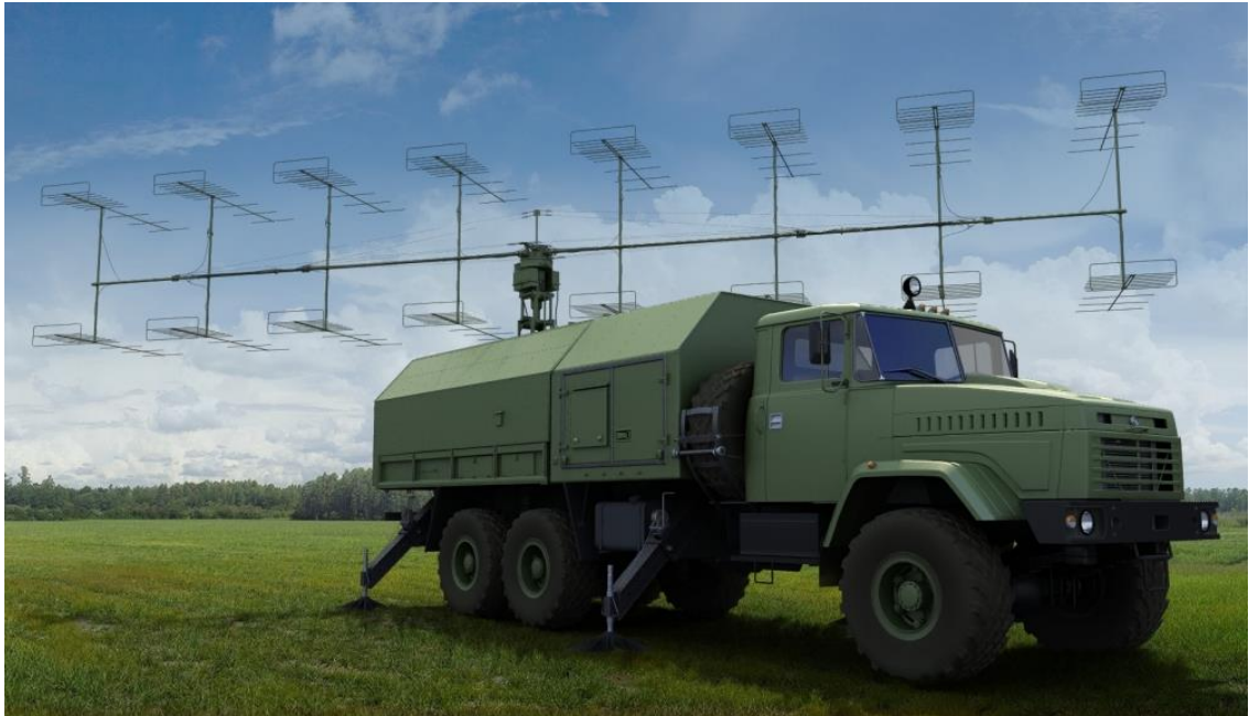
Рис.2.3. Рухома РЛС дальнього виявлення метрового діапазону П-180У.
