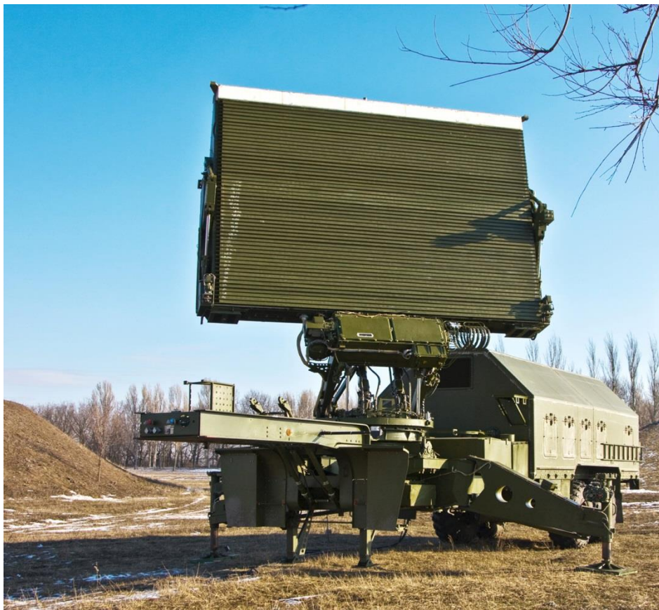
Рис.2.2. Мобільна РЛС кругового обзору з фазованою антенною решіткою.
