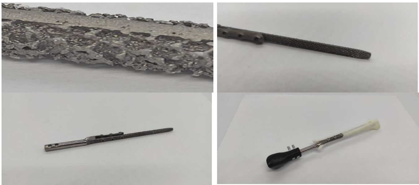
Рисунок 3.8 – Фото імпланту з матеріалу Ti6Al4V , що роздрукований на 3D принтері за технологією SLM
