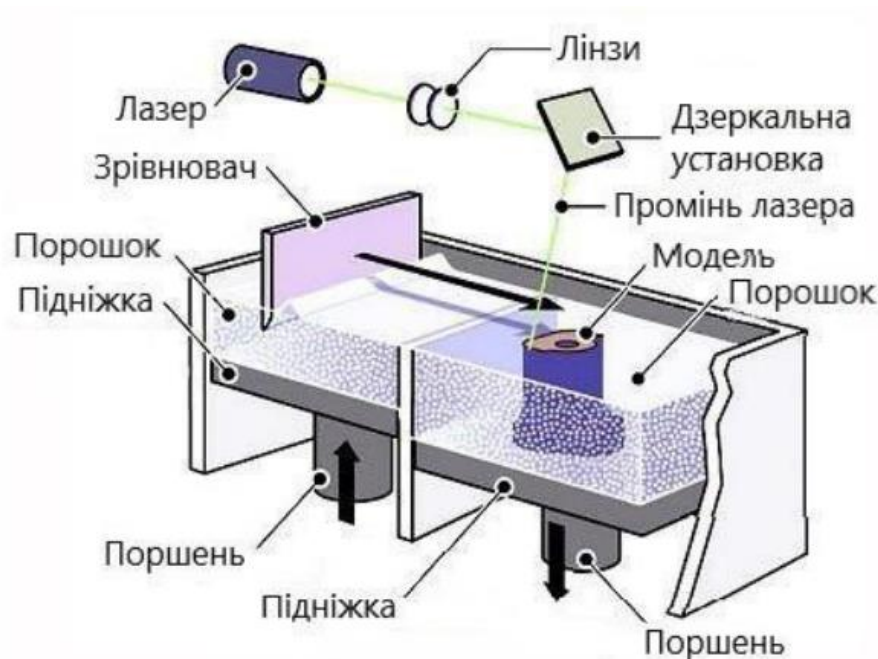
Рисунок 1.6 – Схема установки SLM
