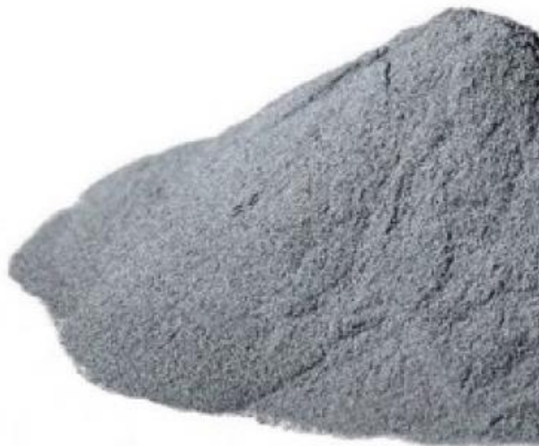
Рисунок 1.10 – Порошок сплаву Ti6Al4V
