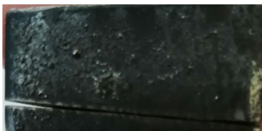
Рисунок 1.4 – Типова морфологія відбитих пошкоджень на тильній поверхні заготовки CFRP
