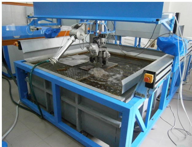
Рисунок 1.2 – Загальний вигляд реальної установки гідроабразивного різання в процесі обробки CFRP
