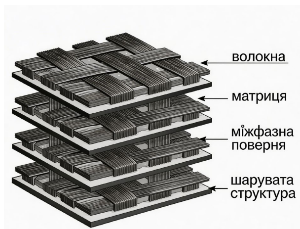
Рисунок 1.1 – Схематична будова вуглепластику: волокна, матриця, міжфазна поверхня та шарувата структура
