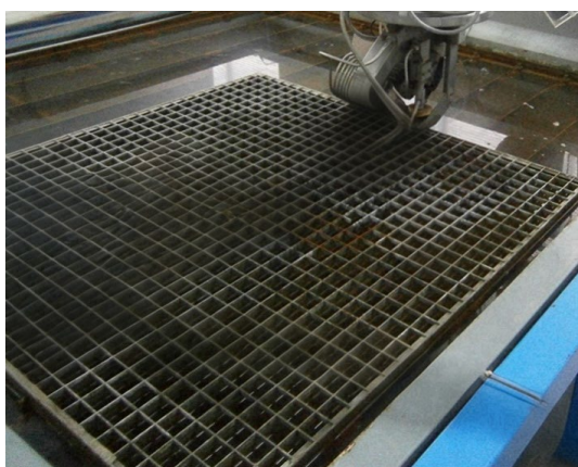
Рисунок 1.3 – Схематичне зображення традиційних способів підтримки заготовки та їх обмежень: сітчаста опора
