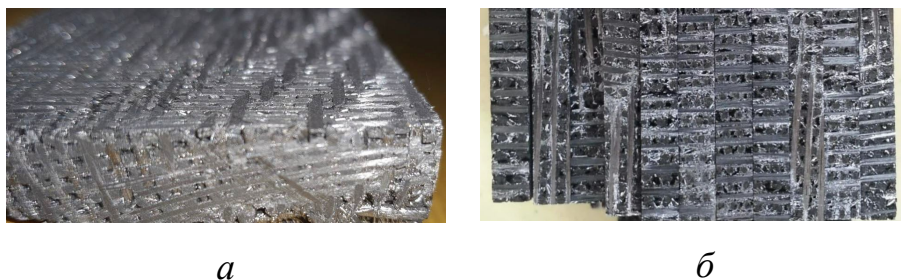
Рисунок 3.5 - Порівняння пошкоджень тильної поверхні при використанні традиційної опори та опори із захистом від розбризкування
