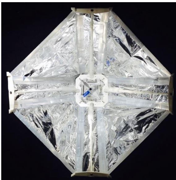
Рисунок 1.1 — Кінечний вигляд сонцезахисного зонту CryoCube [2]
