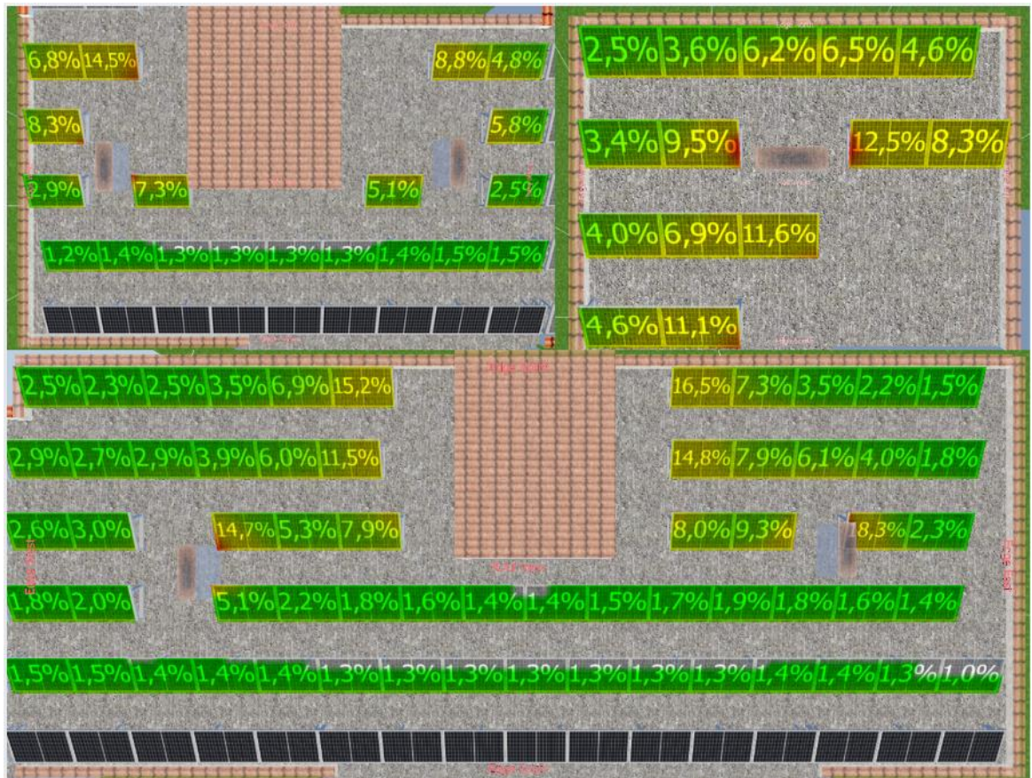
Рисунок 4.4 – Розрахунок затінення фотоелектричних модулів
