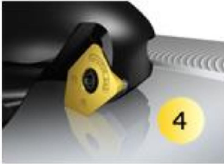
Рисунок 1.6 – Чистова обробка з пластинами Wiper
