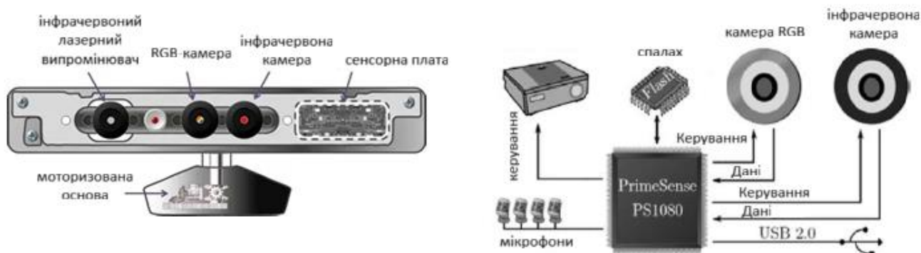
Рисунок 2.1 — Оптична схема сенсора Kinect 1.0 (RGB-камера, IR-камера, IR-проектор) [3]
