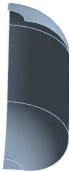
Рисунок 4.5 – Оболонкова модель колби
