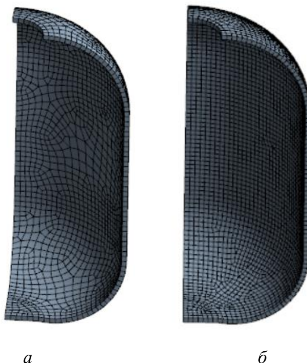
Рисунок 4.6 – Дискретизація числової моделі колби: а – вузлів 1747, скінченних елементів – 1663; б – вузлів – 2927, скінченних елементів – 2832
