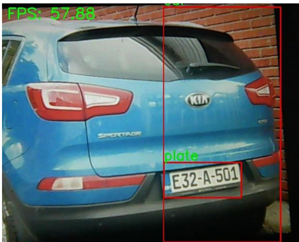
Рисунок 3.21 – Результат виявлення транспортного номеру та класифікація транспортного засобу
