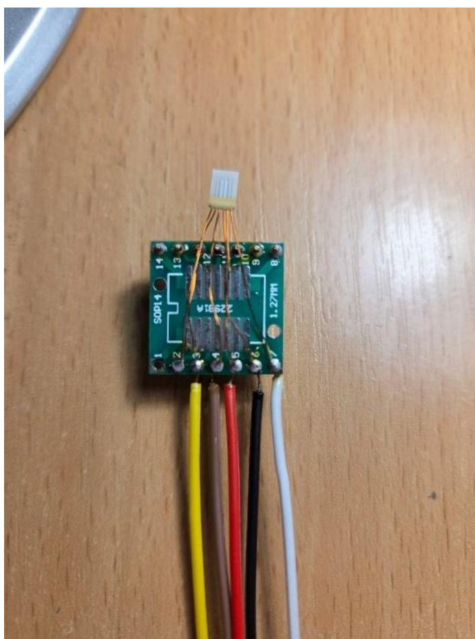
Рисунок 4.5 - Розведення контактів для підключення до ELVIS II
