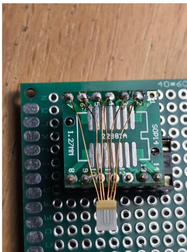
Рисунок 4.4 - Встановлення конструкції сенсора на плату
