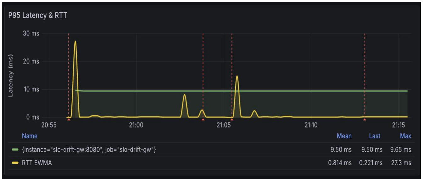
Рисунок 3.5 – зміна 95-го перцентилу затримки під час тестів для політик з адаптацією та без адаптації;
