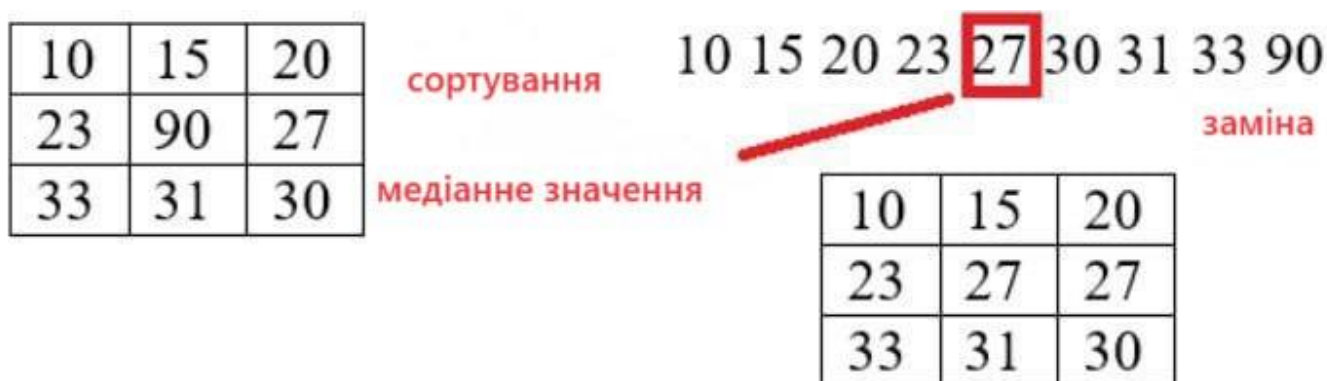
Рисунок 3.2 – Приклад застосування медіанного фільтру.
