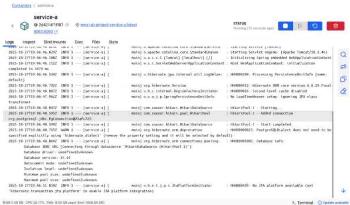
Рис. 2.2 – Логи запуску контейнера мікросервісу service-a, що відображають процес ініціалізації Spring Boot застосунку та встановлення з'єднання з базою даних PostgreSQL через HikariCP
