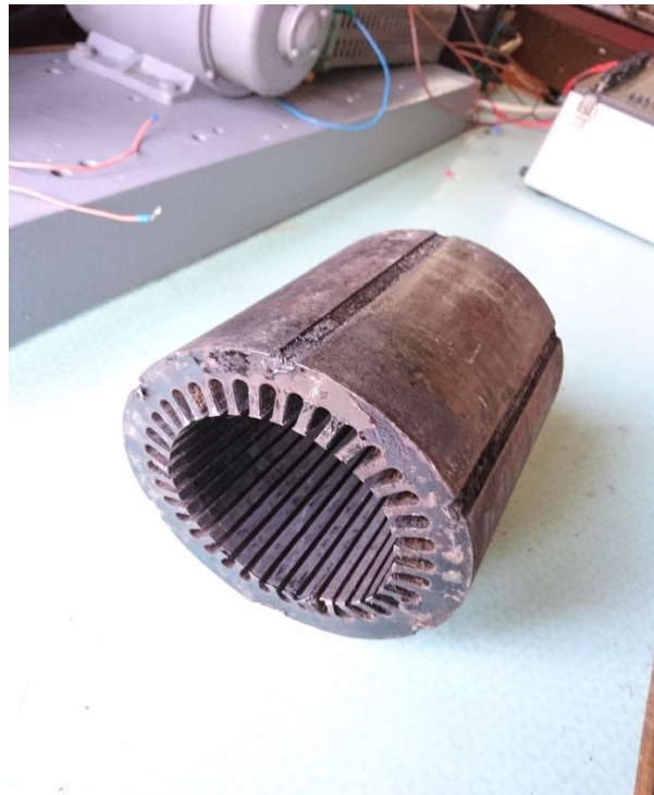
Рисунок 3.2 Фото магнітопровода асинхронного двигуна 4A90L4Y3
