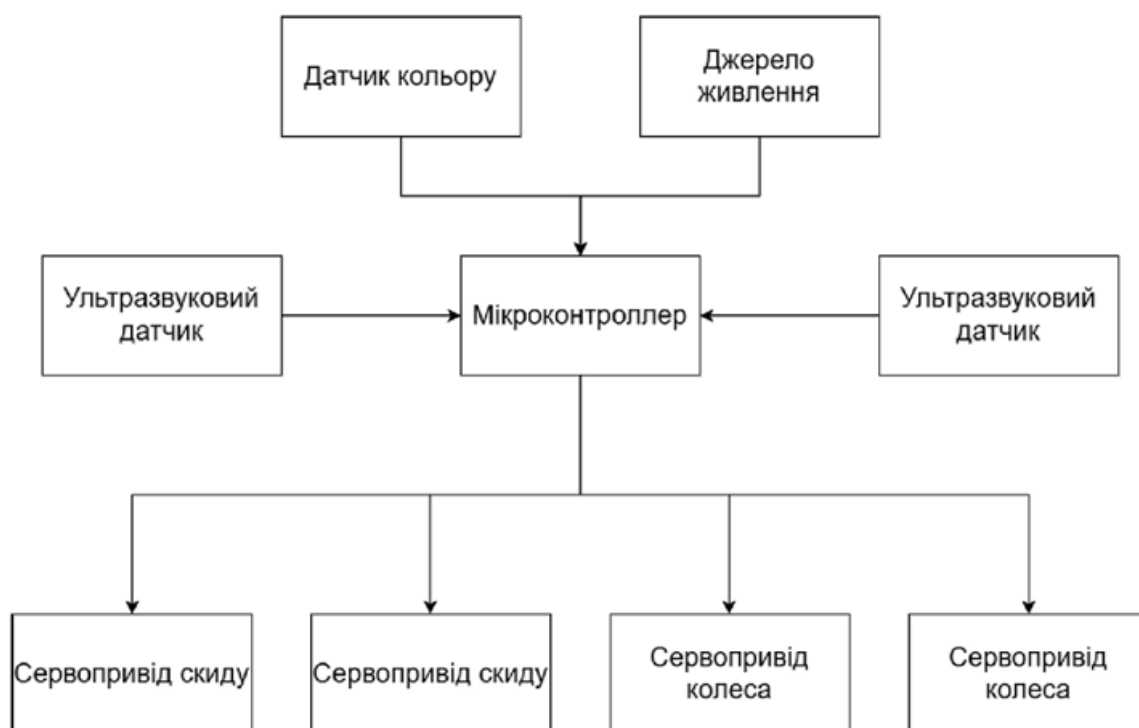
Рис.2.1 Структурна схему прототипу складського робота
