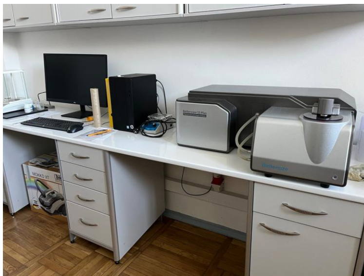
Рисунок 2.3 – Прилад для вимірювання розподілу частинок за розмірами BetterSize 3Plus
