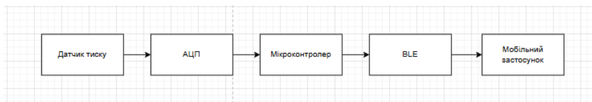
Рисунок 9 – Діаграма потоку даних вимірювання тиску
