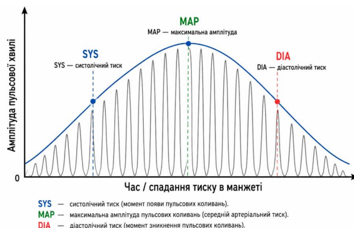
Рисунок 12 – Осцилометричний метод зчитування тиску
