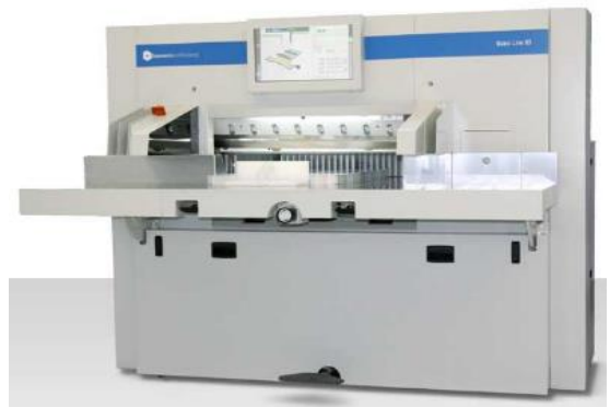
Рисунок 1.2 – Одноножова паперорізальна машина Wohlenberg 80 (Німеччина)
