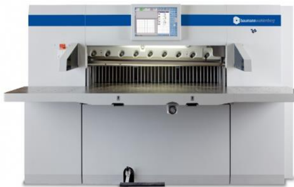
Рисунок 1.1 – Одноножова паперорізальна машина Wohlenberg 115 (Німеччина)
