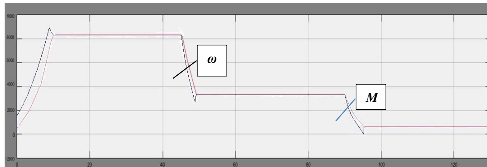
Рисунок 3. Перехідний процес швидкості \omega та моменту M системи ПЧ – АД (з нейроконтролером).
