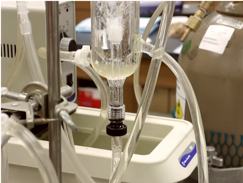
Рис. 2.2. Тензометричне дослідження гладенького м'яза в органній камері. Трахеальне кільце щура підвішене між нерухомим гачком і тензометричним датчиком для реєстрації сили скорочення [jove52324].
