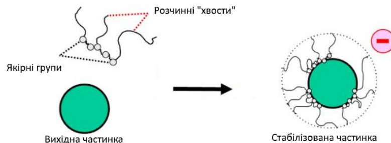
Рис. 17.5 – Схематичне зображення процесу стабілізації
