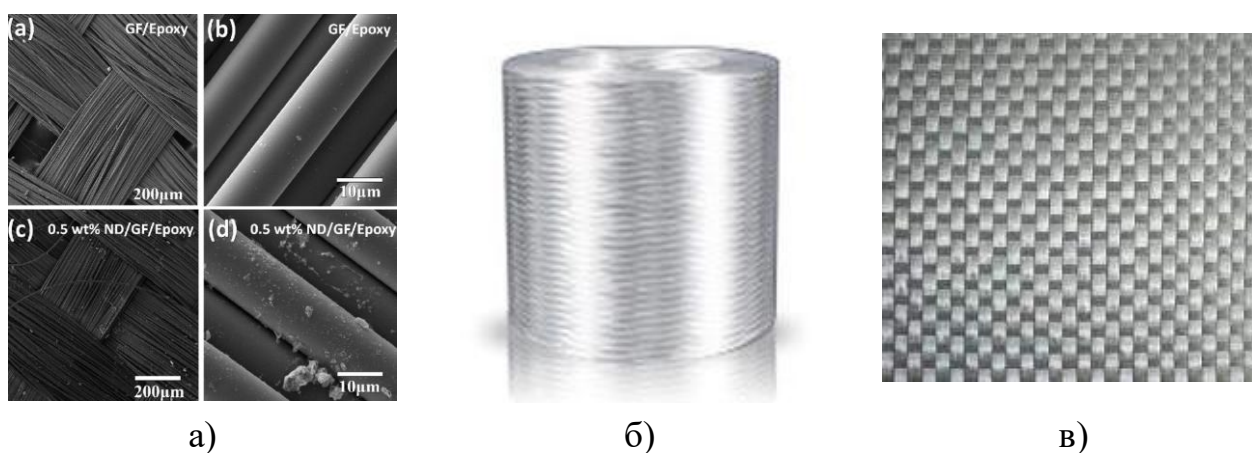
Рис. 6.10 – Скляні волокна: а) SEM-фотографія скляних волокон б) скляна нитка в рулоні (зовнішній вигляд; в) вуглецева тканина (зовнішній вигляд)
