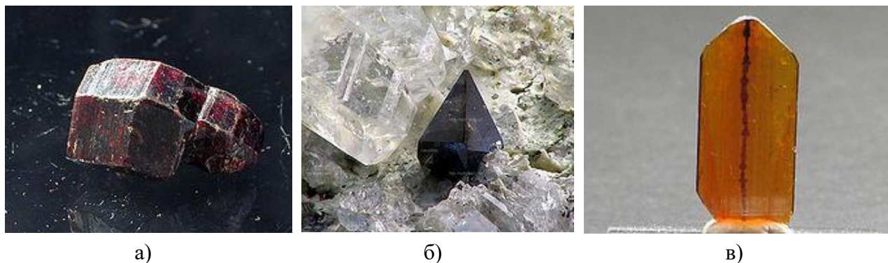
Рис. 11.2 – Мінеральні форми діоксиду титану: а) кристал рутилу з включеннями заліза та ніобію б) кристал анатазу з включеннями заліза та ніобію; в) кристал брукіту зі включеннями заліза, ніобію та танталу
