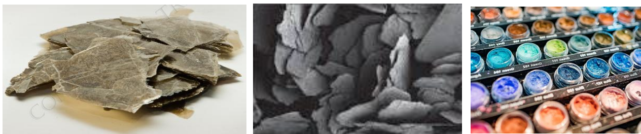
Рис. 6.7 – Слюда: а) мусковіт (зовнішній вигляд); б) мікроструктура частинок; в) використання у вигляді пігментів.
