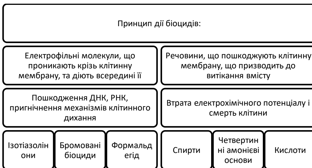
Рис. 15.1 – Принцип дії біоцидів
