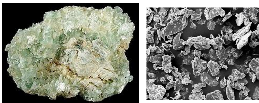
Рис. 6.9 – Тальк: а) необроблений мінерал (зовнішній вигляд); б) мікроструктура частинок
