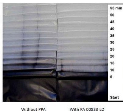
Рис. 9.2 – Покращення поверхні готового виробу/зниження дефектності (за рахунок міграції на поверхню і створення плівки з пониженим поверхневим натягом і підвищеною рівномірністю)
