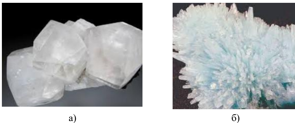
Рис. 6.1 – Мінералогічні форми карбонату кальцію: а) кальцит; б) арагоніт
