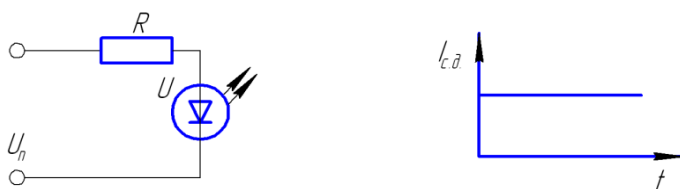
Рис. 1.1. Схема включення (а) та діаграма часу живлення з постійним струмом (б)
