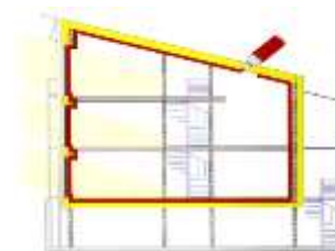
Рисунок 2.1.8 – Утеплення за «правилом олівця» [73]
