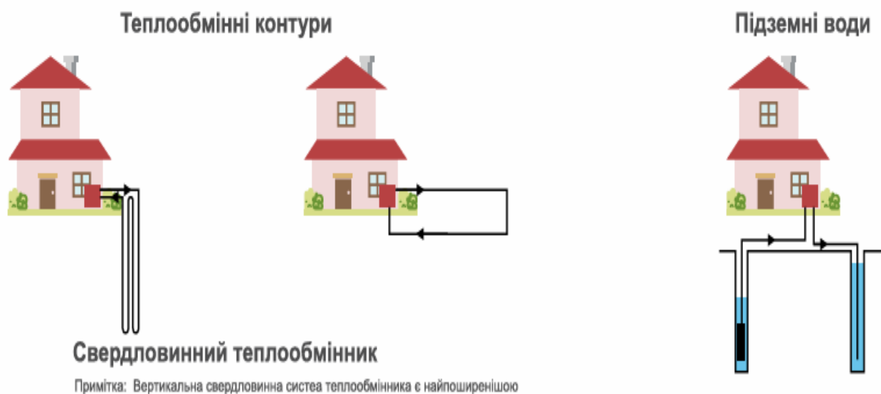
Рисунок 3.1.11 – Геотермальні системи неглибокого залягання доступні в різних типах відповідно до місцевого джерела тепла у вологому/сухому ґрунті [73]
