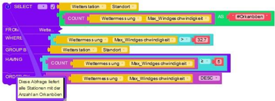
Рисунок 1.1 – Зовнішній вигляд блоків, що реалізують запит до бази даних, у застосуванні BlocklySQL
