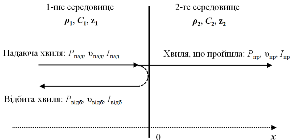
Рис. 3.1. Проходження плоскої хвилі через межу поділу
