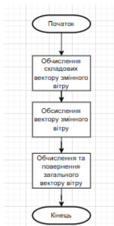
Рисунок 3.8 – Блок схема функції GetWindForce
