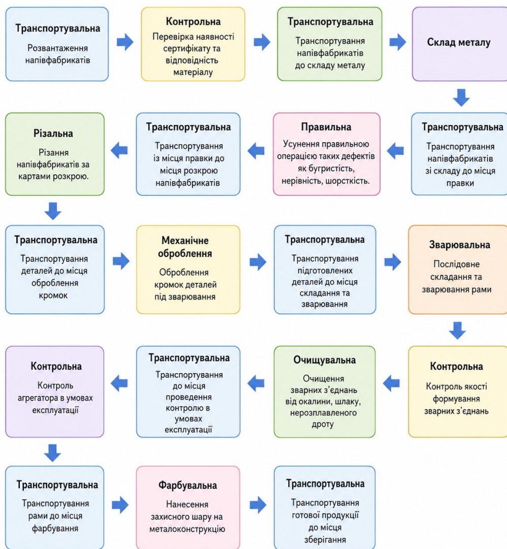
Рисунок 1.6 – Технологічна блок схема операцій виготовлення рами
